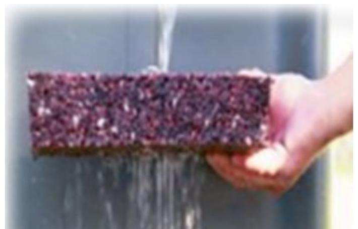
Figura 12. Ejemplo de pavimento permeable (Center for Neighborhood Technology , 2010).
