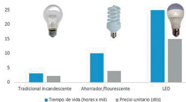
Comparación entre precio y tiempo de vida de tres tipos de focos diferentes.
