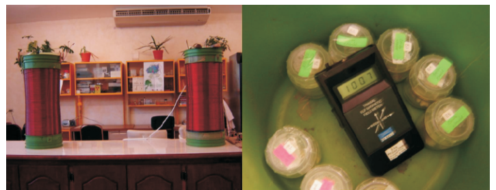
Fig. 2. Solenoides usados en el experimento. A la izquierda se muestran el solenoide apagado (izquierda) y el que se encontraba produciendo el campo electromagnético (derecha). A la derecha una fotografía que muestra los callos dentro del solenoide con el campo electromagnético.
